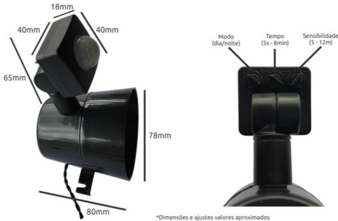
Alarme dedicado autonomo com sirene bivolt 110/220Vac (com ajuste de volume e tom) e sensor de presença integrado com 3 ajustes (tempo, modo e sensibilidade). Alarme ideal e prático para segurança, com ligação simples 2 fios.
